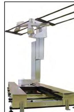
液晶ガラス基板搬送用ロボット
